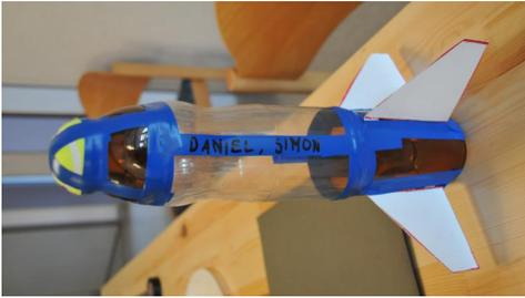
In diesem Artikel wird beschrieben, wie man mit einfachem Material eine Wasserrakete bauen kann, welche bis zu 50m hoch fliegt!
