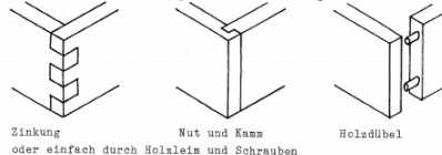
Zinkung oder einfach durch Holzleim und Schrauben
