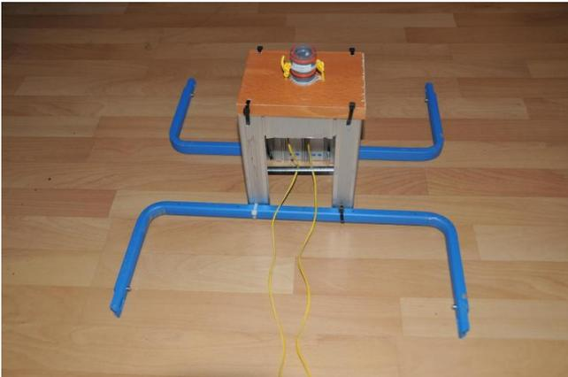
El último paso consiste en fijar los soportes a la carcasa para que la plataforma de lanzamiento pueda fijarse al suelo con piquetas y no vuelque. Para ello utilicé los soportes metálicos de un viejo electrodoméstico. Esta construcción no ganará ningún premio de belleza, pero cumple el objetivo deseado ;)
