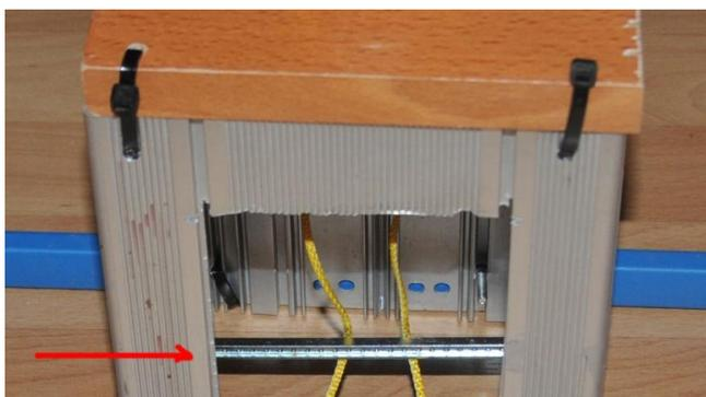
En el lateral de la carcasa se ha practicado una abertura por la que puede salir el cordón y entrar la manguera de la bomba de bicicleta. Además, se inserta una varilla en el interior de la carcasa para desviar el cable
