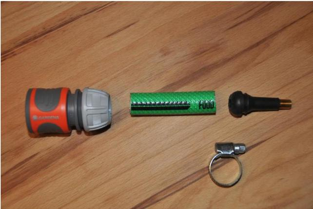
El reborde de la válvula del coche se mecaniza hasta que encaje perfectamente en el trozo de manguera de jardín. La válvula se introduce tanto en la manguera que sólo sobresale la parte metálica y se fija con dos abrazaderas. El otro extremo de la manguera se introduce en el acoplamiento Gardena y se fija. Ahora se sujeta un cable al cuello del acoplamiento de la manguera con la brida para cables de la izquierda y la derecha. Éste debe tener varios metros de longitud.
