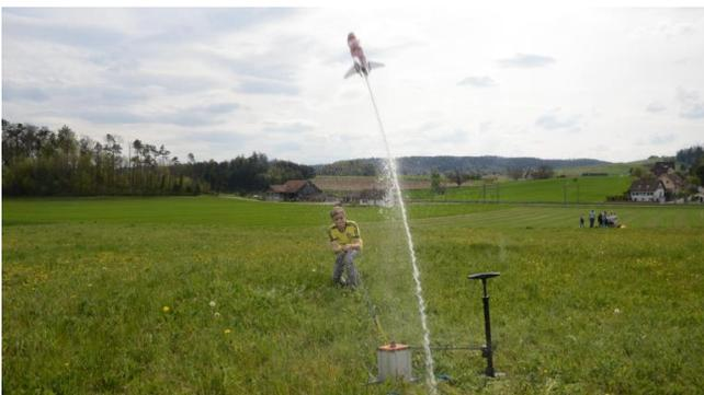
Para lanzar el cohete, se coloca la plataforma de lanzamiento y se fija en una zona adecuada. Se conecta la bomba de bicicleta a la válvula del coche y se llena el cohete con agua hasta un tercio del volumen de la botella. A continuación, se coloca la botella en la plataforma de lanzamiento con un rápido movimiento basculante, a ser posible sin perder nada de agua.
