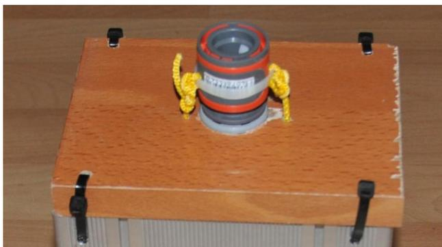
Se taladra un orificio del tamaño de la parte inferior del acoplamiento de manguera Gardena en la parte superior de la carcasa de madera, metal o plástico. La parte inferior del acoplamiento (gris claro en la imagen) debe encajar perfectamente en el orificio sin obstaculizar el movimiento de la parte superior. A la izquierda y a la derecha del orificio se taladran dos orificios más pequeños para pasar el cable.
