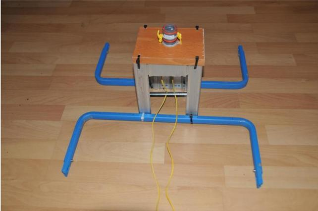
La dernière étape consiste à fixer des équerres sur le boîtier afin que la rampe de lancement puisse être fixée au sol à l'aide d'anneaux de tente et ne se renverse pas. J'ai utilisé pour cela les étriers métalliques d'un vieil appareil. Cette construction ne gagnera pas de prix de beauté, mais elle remplit l'objectif souhaité ;)
