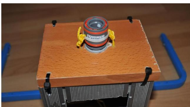
Le cordon est ensuite enfilé à travers les deux petits trous et le module d'accouplement des tuyaux est introduit dans le trou et pressé. Il s'est avéré utile de ne pas coller ce module, de sorte qu'il peut toujours être retiré à des fins de réparation.
