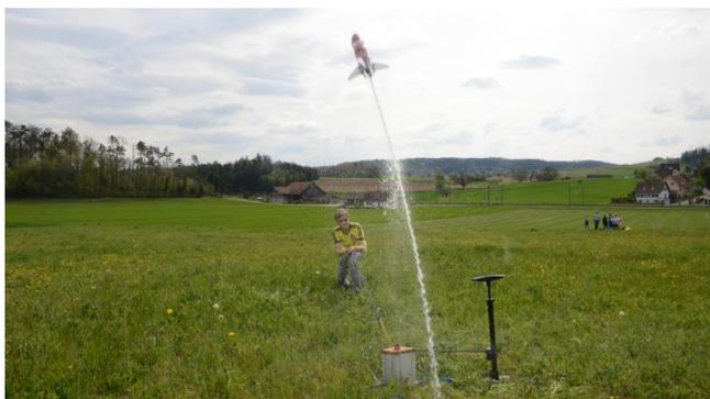
Pour le lancement de la fusée, la rampe de lancement est maintenant placée et fixée sur un terrain approprié. La pompe à vélo est raccordée à la valve de la voiture et la fusée est remplie d'eau à hauteur d'un tiers du volume de la bouteille. Ensuite, la bouteille est placée sur la rampe de lancement avec un mouvement de bascule rapide, si possible sans perte d'eau.
