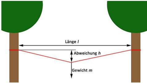
Für den Laien ist es sehr schwer abzuschätzen, wie stark ein Seil belastet bzw. angezogen werden darf. Dieser Artikel soll sensibilisieren, dass man auch moderne Seile nicht beliebig anziehen soll und zeigen welche Belastungen zulässig sind. Es werden ausschliesslich Belastungen an eben (ohne Steigung) gespannten Seilen behandelt.
