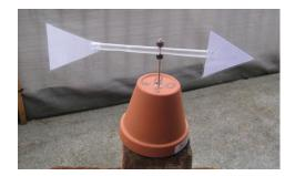
Ein Windrichtungsgeber, Windfahne oder Wetterfahne genannt, ist ein Anzeigeinstrument zur Ermittlung der Windrichtung. Ein bewegliches Messelement richtet sich am dynamischen Druck des Windes aus.
