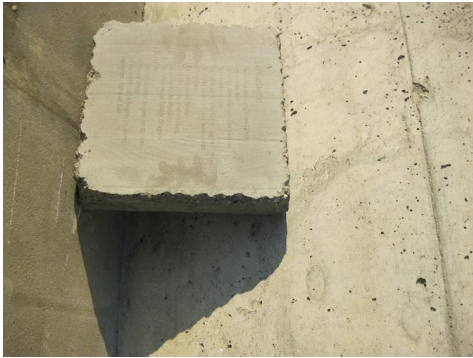
Das Betonieren und Beschriften von Betontafeln
