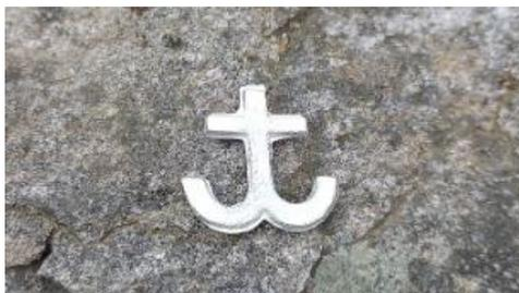
Aqueça a lata em um fogão de acampamento até que fique líquida. Em seguida, despeje no molde preparado. Depois de esfriar, lixe a figura de estanho com limas até que ela se encaixe.
