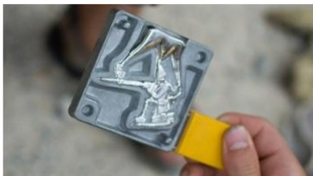
Deixe o estanho esfriar no molde até que esteja frio no ponto de vazamento. (sinta com o dedo) Assim que o estanho esfriar, solte a braçadeira de parafuso, coloque os pedaços de madeira de lado e abra o molde.
