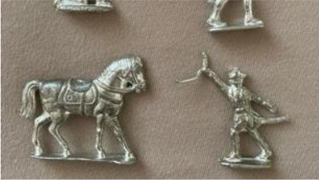
Em seguida, pressione a figura para fora do molde e corte o excesso de estanho. A figura ainda pode ser finalizada com limas e lixa.
