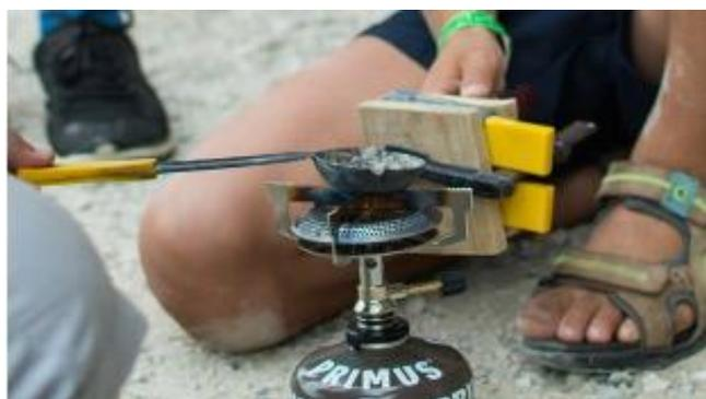
Os moldes são então pressionados entre dois pedaços de madeira usando uma braçadeira de parafuso. Enquanto isso, o estanho é aquecido em uma panela pequena em um fogão de acampamento até derreter. Assim que o molde e o estanho estiverem prontos, o estanho líquido pode ser despejado no molde até que ele esteja cheio.
